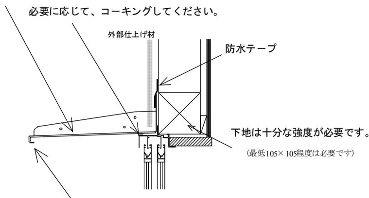
縦滑り出し窓、ドアの場合、障子を開いた時障子と庇先端との間隔に注意してください。
